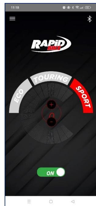
**Note:** スマートフォンの電源を切ったりアプリを閉じたりしても、Rapid Bikeのコントロールユニットは最後に行った設定を保持します。エンジンを切ったりコントロールユニットを外したりしても、最後の設定は記憶されたままです。電源を入れ直すと、最後に選択したMAPで再起動します。
