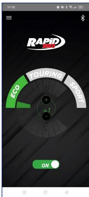
バイクを初めて始動すると、デフォルトでは、日常の運転向けに設計された中間設定であるTOURINGマップが選択されています。
